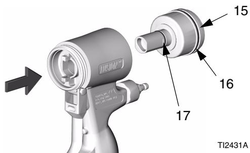
**6.** Обильно смажьте уплотнительные кольца плунжера. Установите обратно плунжер. Стержень имеет ключ для правильной сборки. Сильно надавите для посадки плунжера.
