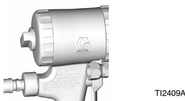
2. См. Таблицу 1. Смотрите также идентификационную таблицу в **Комплекты сверл**, стр. 39. Воспользуйтесь сверлом подходящего размера для очистки сопла камеры смешивания (N). При необходимости, осторожно очистите воздушную головку (C) с помощью жесткой щетки.
